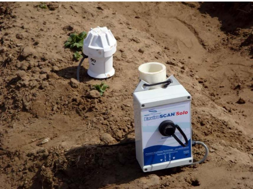
与百事食品生产基地之前使用的由 EnviroScan RT6 Logger 配合 EasyAG 探头组成的土壤水分测量系统相比，EnviroScan Solo 系统具有安装简单，便携性强，方便管理、精度更高等特点。其最先进之处在于每个传感器探头均由一个 EnviroScan Solo 单元盒控制，两者之间的线缆仅几米长，改变了以往的由一个数采控制多个探头所造成的线缆繁多的问题，从而减少了很多用户维护、使用的工作量，并进一步保证了监测数据的稳定可靠性。
