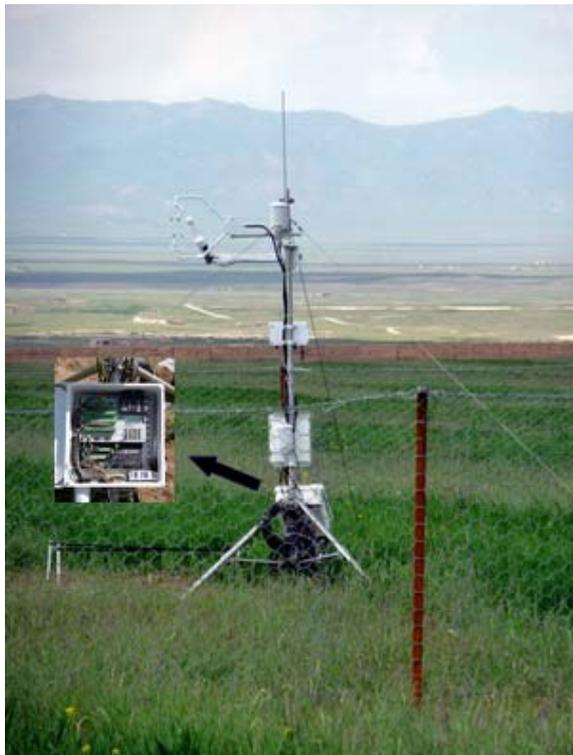
土壤含水量传感器所获得的数据进行收集、处理和存储。全系统可以在-55℃~+80℃的极端环境下稳定可靠工作，从而保证了研究观测活动的顺利进行。
