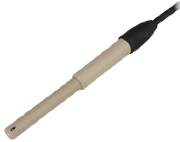
CS525采用创新型设计的ISFET pH探测元件(Ion-sensitive field-effect transistor, ISFET)，能够有效降低极限条件下的pH测量误差。CS525设计优良，制作精湛，符合ISO9000和CE标准；环境适应性强，全密封设计，能够有效防止积垢、污染，在含有腐蚀性化学品、生物制剂的水体环境中亦能正常工作，而这是采用传统玻璃制pH探头所无法实现的。CS525的外壳采用聚醚醚酮材料，能够为电子元件提供安全可靠的保护。
